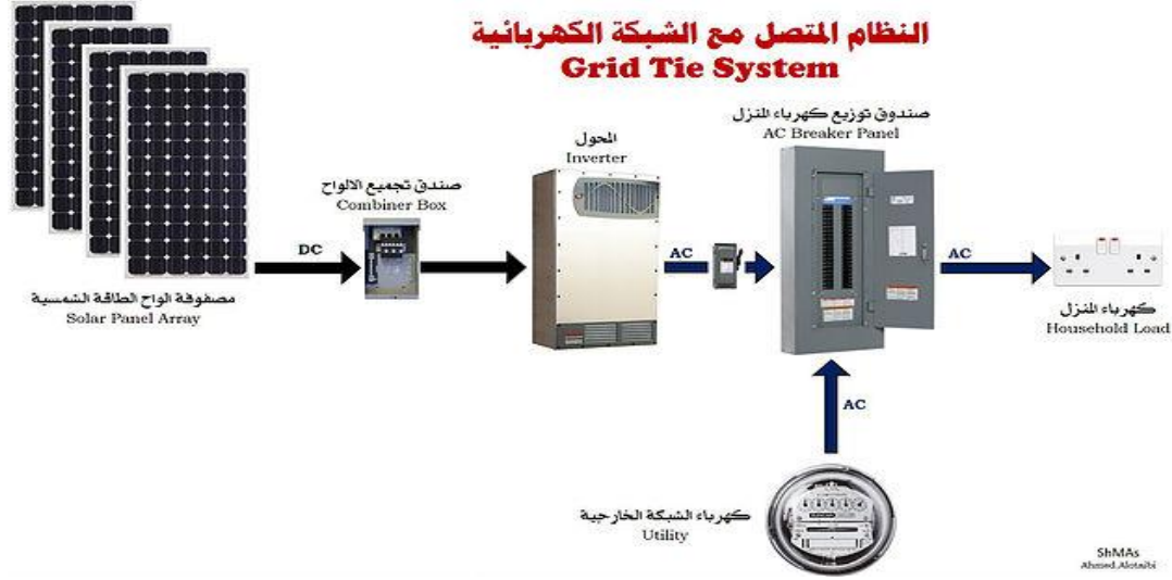
شكل (10.3): النظام الشمسي المرتبط مع الشبكة
